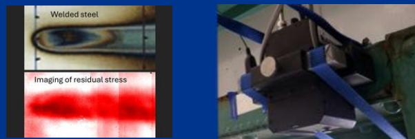
塑性変形、欠陥、転移など、組成レベルの変化を高感度に検出します
